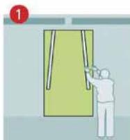
1 Colocar los paneles en la pared e instalar la estructura metálica donde irá fijada la campana.
